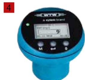
**1 BSB Messsystem OxiTop®-IDS zur Bestimmung der aeroben Abbaubarkeit**
