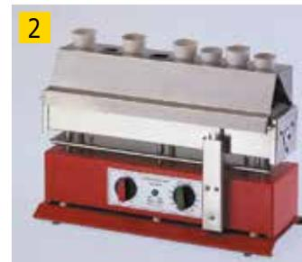
Für Einzel- und Serienveraschung fester und flüssiger Substanzen. Obere Etage mit 8 Öffnungen von 34 mm Ø, für Porzellantiegel bis 50 mm Ø passend. Oberteil und Gehäuse aus Edelstahl rostfrei. 120 Minuten-Schaltuhr mit Glockensignal nach Zeitablauf und Schaltstellung für DAUER EIN. Die Sicherheitsschaltung schaltet bei Öffnen des Veraschungsraums das Gerät automatisch ab und bei Schließen der Klappe ein. Mit 1,5 m Kabel und Schukostecker.
